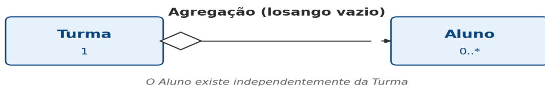
Diagrama UML de agregação entre Turma e Aluno.
